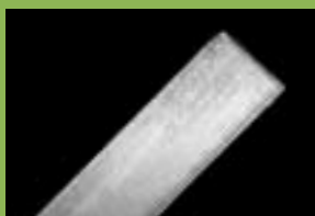
UD vlákno - vlákna uložena jednosměrně do válcového tvaru umožňují odebrat potřebné množství vláken a tím si můžete sami regulovat sílu vrstvy vláken. Dále je tato varianta vhodná pro vytvoření individuálního kořenového čepu. Barvy copánku a svazku vláken: růžová nebo bílá.
