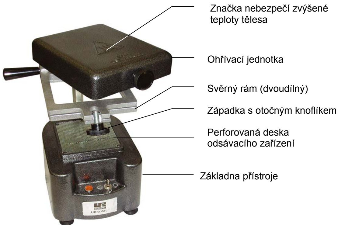
UltraVac – popis základních částí přístroje
