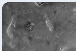
Povrch keramiky před leptáním.
