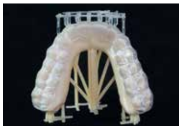
Kombinace dlahy a modelu vytištěných 3D tiskárnou
